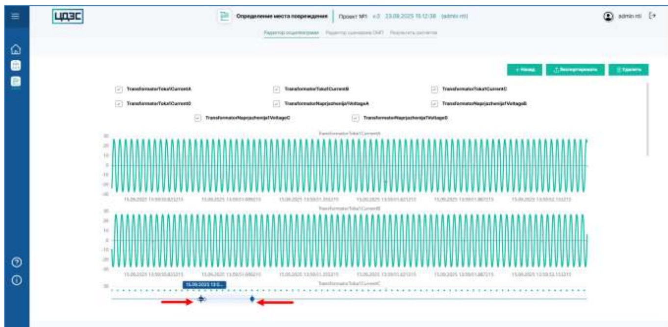
Рисунок 23 – Страница экрана «Редактор осциллограмм» программного обеспечения «Определение места повреждения», изменение временного отрезка окна наблюдения на экране просмотра импортированной осциллограммы
